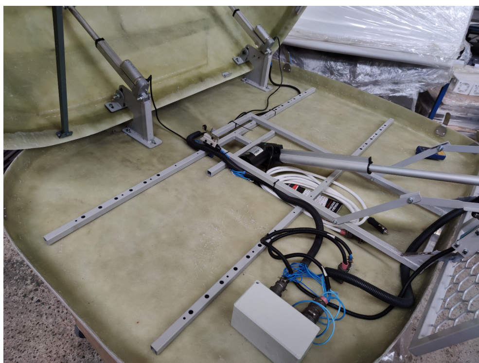
Рис.4 Фото армирующих планок с отверстиями для крепления к багажнику автомобиля.
